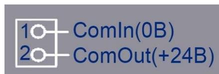
Рисунок 3.16 - Расположение контактов разъёма «X6» преобразователя BSD
